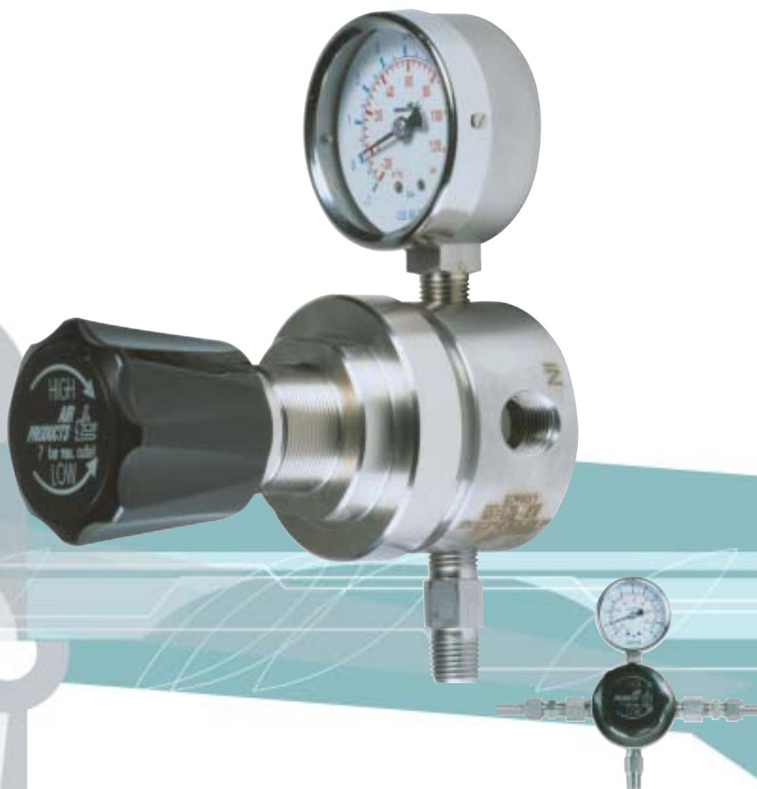
➤ Cette gamme de détendeurs en acier inoxydable a été conçue pour la mise en œuvre de gaz pur et/ou corrosifs, à l'exception de l'oxygène. Les détendeurs de ligne LR3600 sont équipés d'une vanne ayant un coefficient de débit CV égal à 1.0, permettant une bonne régulation de la pression de sortie et autorisant des débits importants.
