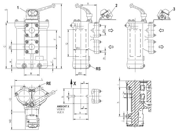
RE Entlüftung G1/4 vent G1/4 désaération G1/4 RS Entleerung G3/8 drain G3/8 vidange G3/8
